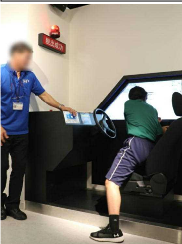
道路が浸水した場合、水深30cmで30kgの重さ、50cmでは100kgの重さになるドアを全力で開ける。50cm以上になると大人の方でも脱出することは不可能だ。
